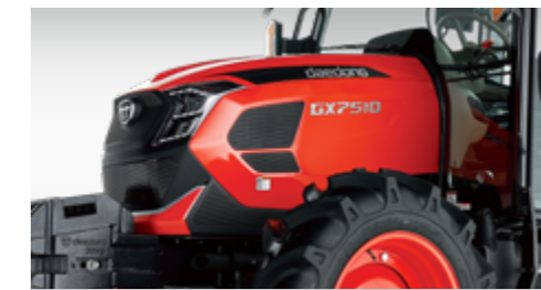
원사이드 방식 일체형 보닛 기존 대비 80mm 늘어난 높이로 압도적인 비례감 표현. 입체적인 측면 디자인을 구현하고 오픈각 60도를 확보해 정비성 향상. 스틸 재질을 적용해 강도 향상
