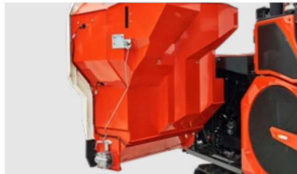
윈터치 핀방식 곡물탱크 고정핀 해제만으로 손쉬운 오픈 가능
