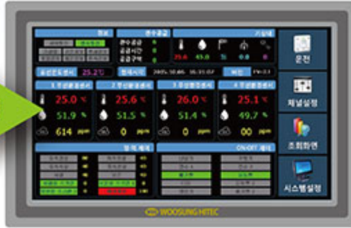
팜시스 메인화면 · 센서값, 경보, 작동상태 · 통신이상 데이터 표시
